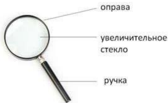
Рис. 1. Строение ручной лупы
